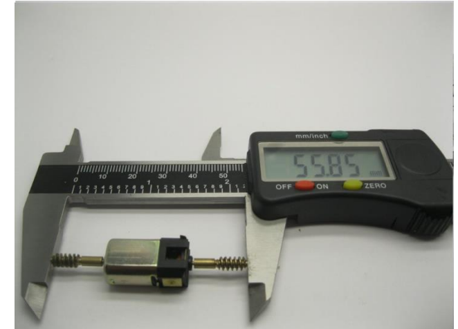
Maße prüfen Check dimensions Controleer de maatvoering
