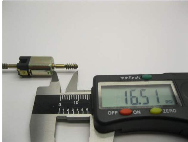
Maße prüfen Check dimensions Controleer de maatvoering
