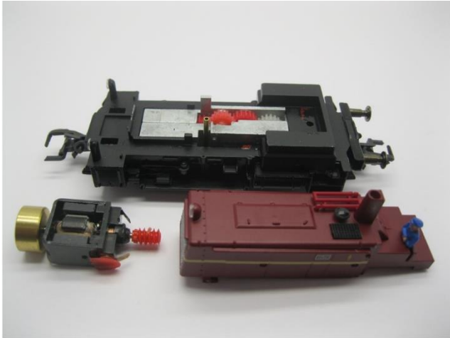
Ausbau alter Motor Take out the old motor Verwijder de oude motor
