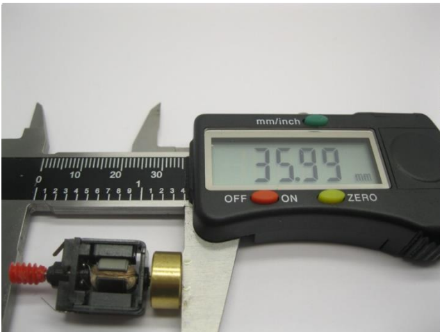
Maße prüfen Check dimensions Controleer de maatvoering
