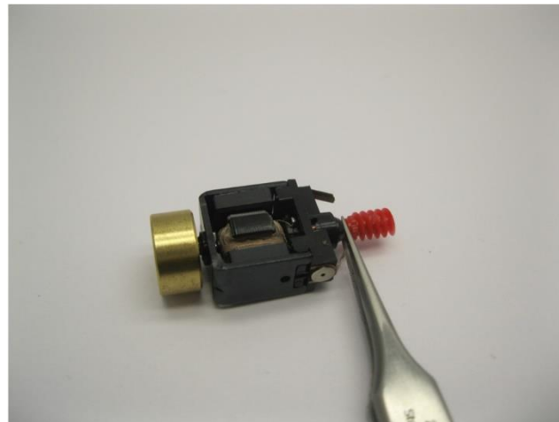
Sie brauchen dieses Teil wieder. Diese kann mit einer Pinzette entfernt werden You need the part again. It can be removed with tweezers U heeft het onderdeel opnieuw nodig. Het kan verwijderd worden met een pincet
