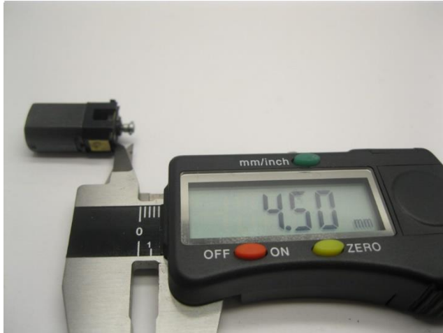
Maße prüfen Check dimensions Controleer de maatvoering
