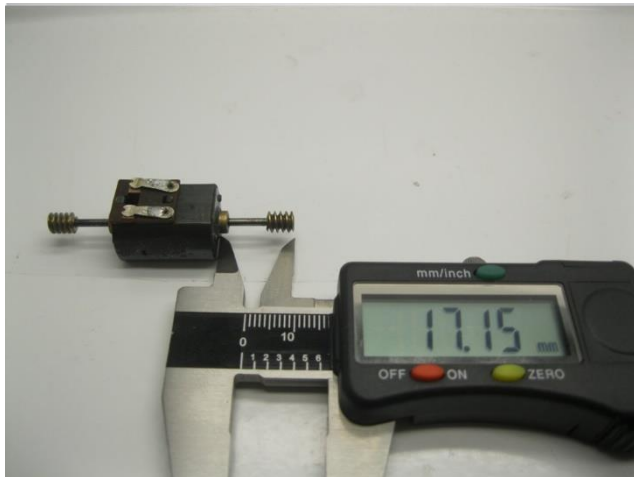
Maße prüfen Check dimensions Controleer de maatvoering
