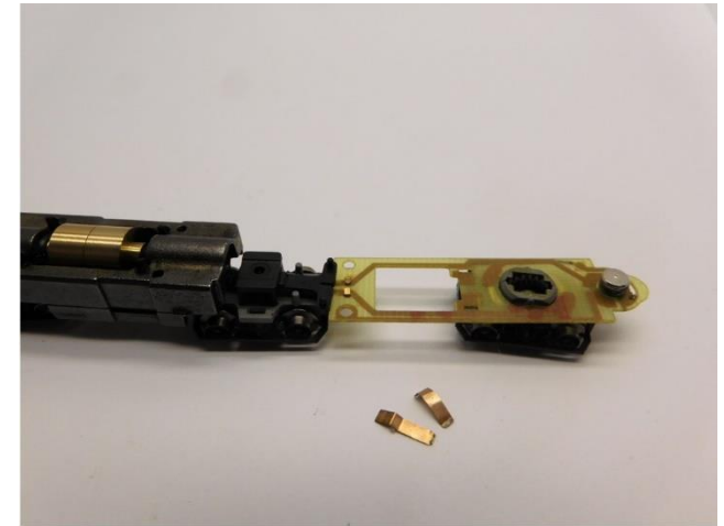
Alter Motorkontakte entfernen Remove old motor contactss Verwijder de oude motorcontacten
