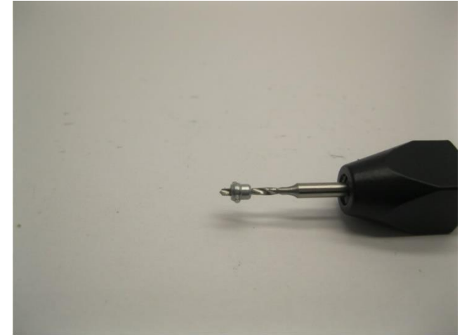
Vergrößern Sie das Loch auf 1.2 mm Enlarge the hole to 1.2 mm Vergroot het gat naar 1.2 mm
