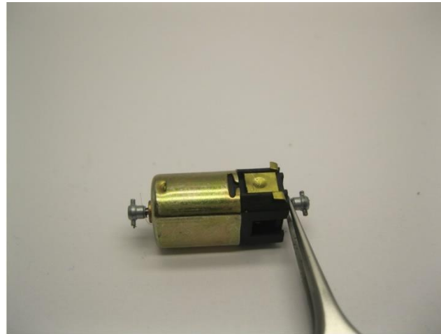
Entfernen Sie die Kardankupplungen mit einer Pinzette Remove the cardan couplings with tweezers Verwijder de kardankoppelingen met een pincet
