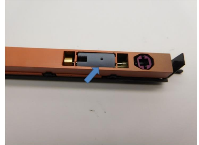
Wir haben den Motor mit 1 Tropfen Kleber fixiert We fixed the motor with 1 drop of glue Wij hebben de motor gefixeerd met 1 druppel lijm
