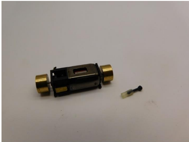
Entfernen Sie die Kardankupplung mit einer Pinzette Remove the cardan coupling with tweezers Verwijder de kardankoppeling met een pincet
