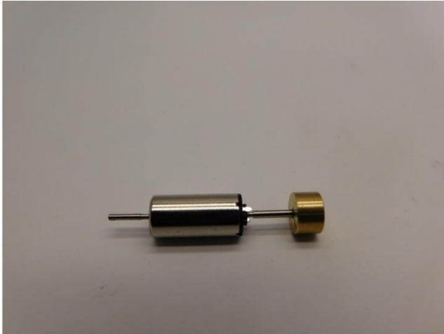
Die Metallteile sind geklebt The metal parts are glued De metaaldelen zijn verlijmd
