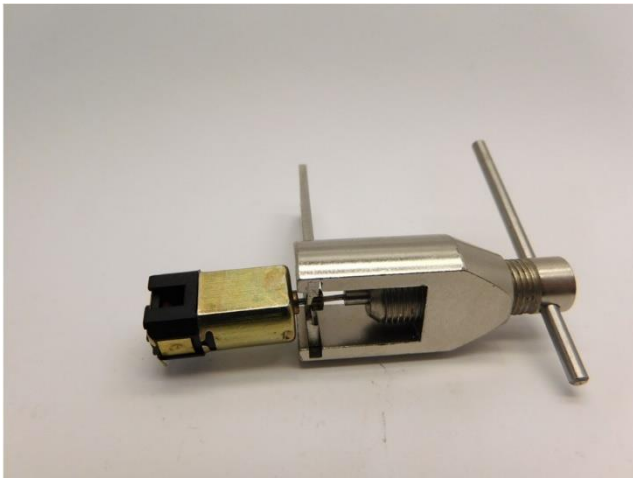
Sie brauchen dieses Teil wieder. Dies wird mit einer Ritzelabzieher entfernt You need the part again. It can be removed with a gear puller Je hebt het onderdeel wederom nodig. Het wordt verwijderd met een tandwieltrekker
